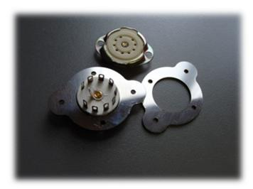
Переходное кольцо для установки ламповых панелей керамических (ПЛК9) на монтажное шасси / в корпус лампового усилителя производства «Золотая Середина» на места, предназначенные для установки 8-штырьковых октальных ламповых панелей.
