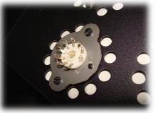
Переходное кольцо для установки 9-штырьковых ламповых керамических панелей тип ПЛ9-КД/КЭ и 7-штырьковых ламповых панелей на монтажное шасси / в корпус лампового усилителя производства «Золотая Середина» на места, предназначенные для установки 8-штырьковых октальных ламповых панелей.
